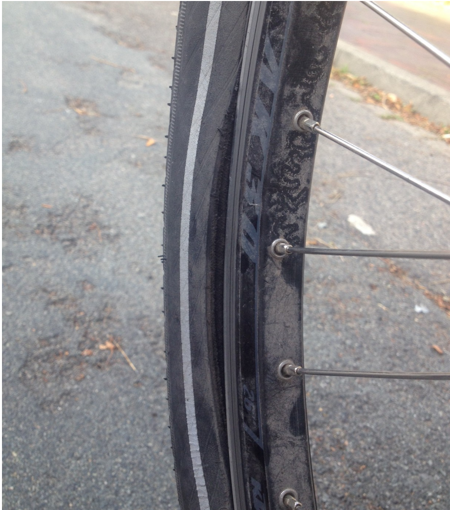
Karkassenschaden. Achtung, Schlauch streift an Bremse: plötzliches Platzen des Schlauches!
